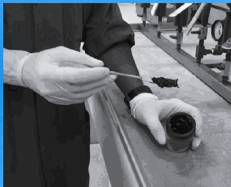
Рис. 2: Моторное масло, подвергнутое серьёзному перегреву.
