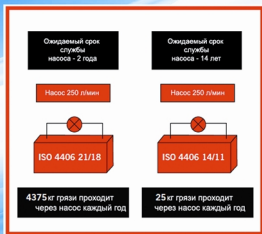
Рис. 6: Влияние грязного масла на срок службы гидравлической системы.
